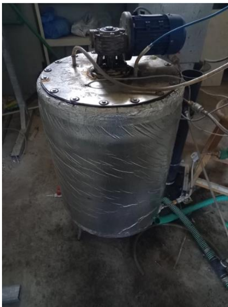
Σχήμα 98 Ο βιοαντιδραστήρας πιλοτικής κλίμακας που χρησιμοποιήθηκε για την αναερόβια συν-χώνευση του μίγματος FMSW condensate/WAS.
