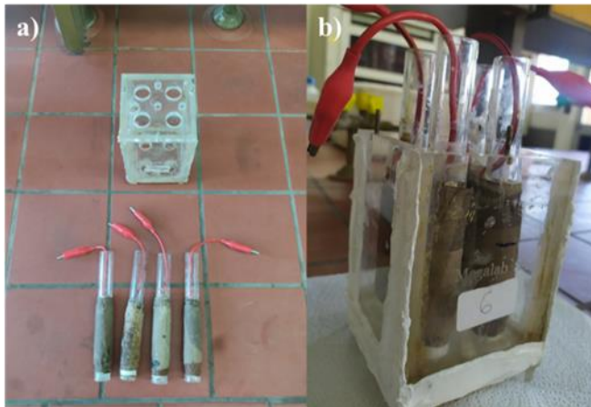
Σχήμα 72 MKK από Plexiglas και τέσσερα καθοδικά ηλεκτρόδια, τα οποία τοποθετήθηκαν στις οπές του διαμερίσματος της MKK.
