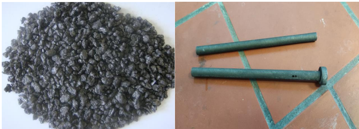
Σχήμα 74 Κόκκοι γραφίτη και ράβδος γραφίτη, που χρησιμοποιήθηκαν ως ανοδικό ηλεκτρόδιο σε κάθε ΜΚΚ.
