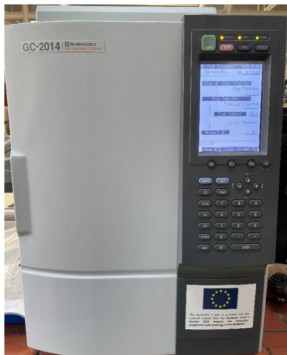
Εικόνα 7 Αέριος Χρωματογράφος για εύρεση σύστασης βιοαερίου
