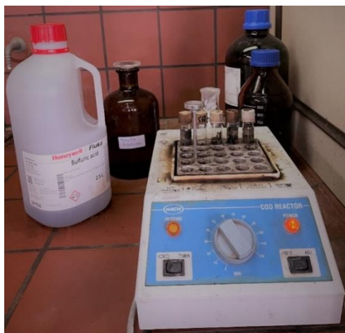
Εικόνα 5 Φούρνος στους 150 C για θέρμανση των δειγμάτων και πραγματοποίηση της αντίδρασης μεταξύ οργανικού υλικού και διχρωμικού ιόντος
